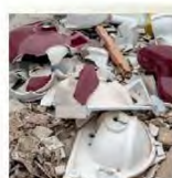
Les gravats ou déchets de même nature (Béton, Faïence, Wc ou lavabo, Tuiles)
